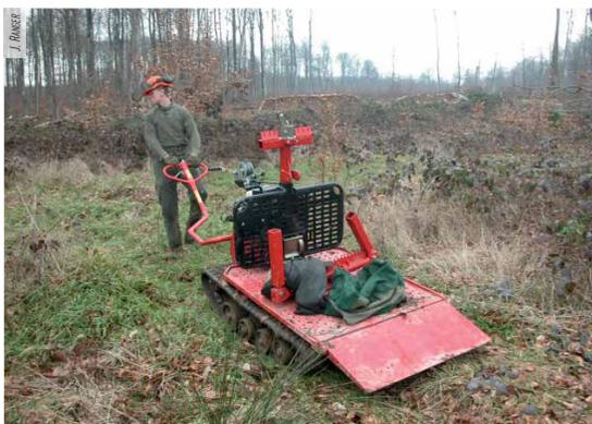
**Figure 30.** Le cheval de fer, petit engin mécanique utilisé pour le débusquage et le débardage de petites grumes, dont l'empreinte au sol est très faible (site expérimental Azerailles, 54).
