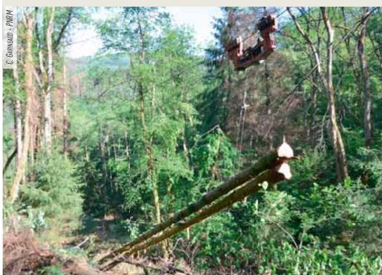
Débardage de bois longs par câble mât réduisant très fortement les dégâts au sol et à l'écosystème.
